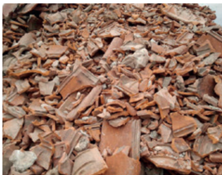
Tagsten fra nedrivning.
