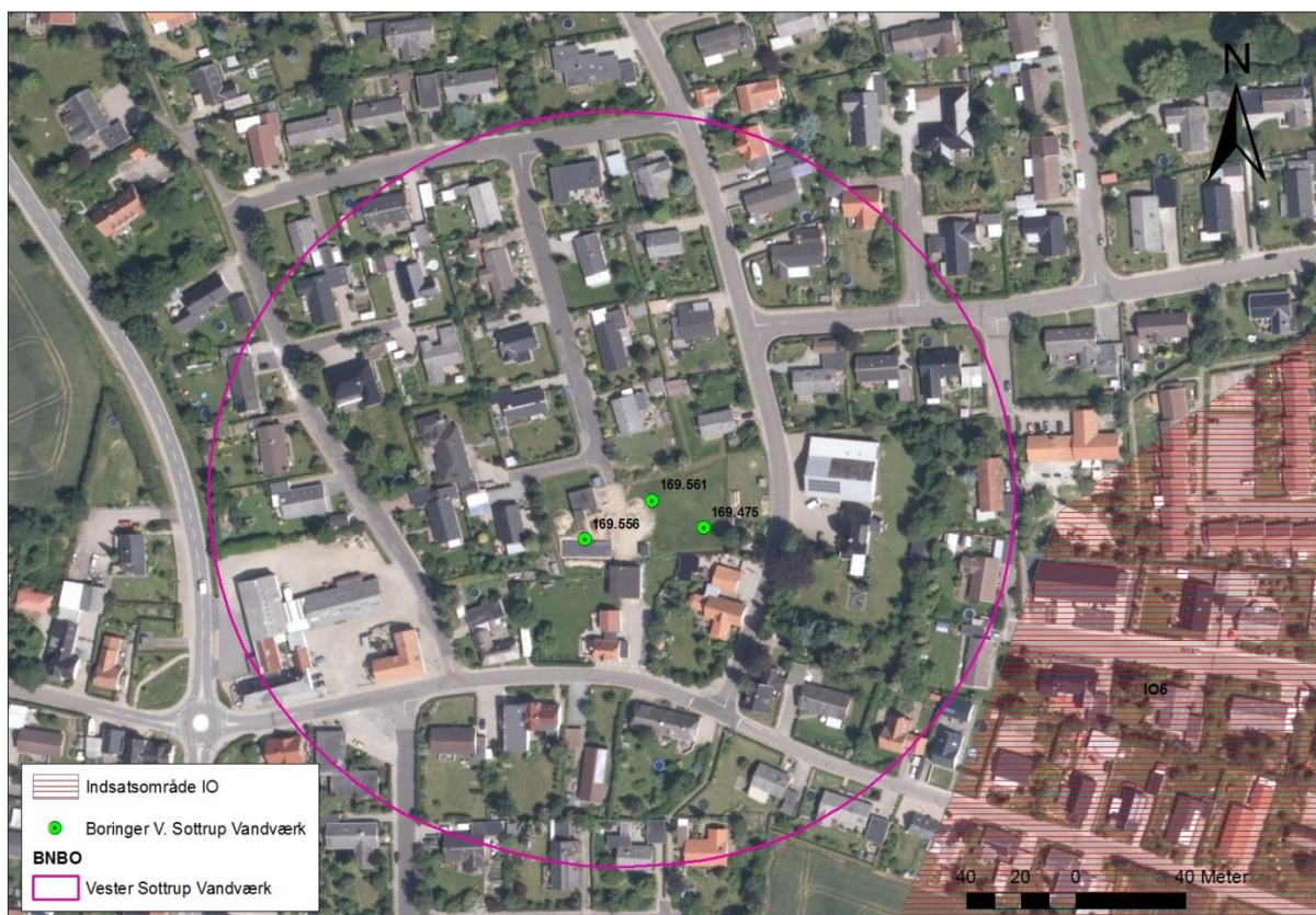
Figur 6-12: BNBO omkring kildepladsen ved Vester Sottrup Vandværk.
